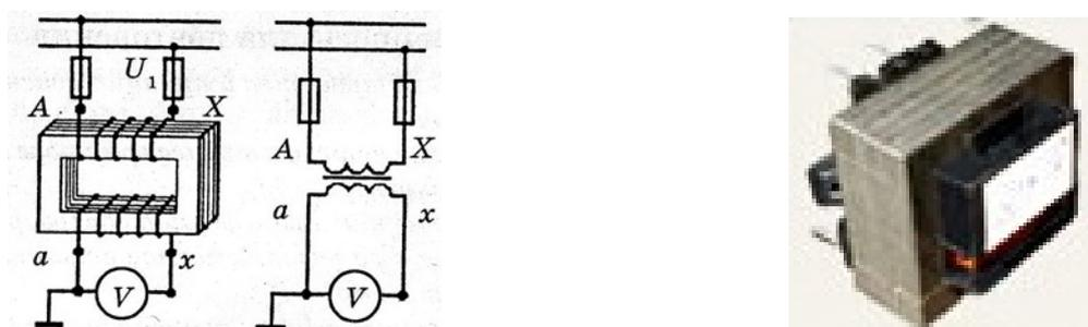
Рис. 9. Трансформаторы напряжения.
