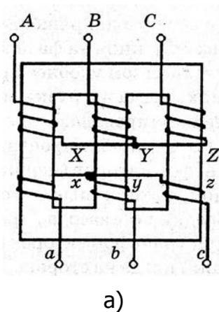
Рис. 4. Трёхфазный трансформатор: а) соединение обмоток звездой; б) высоковольтный масляный трансформатор
