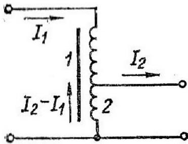
Рис. 5. Понижающий автотрансформатор
