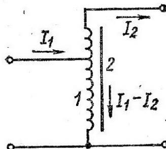
Рис. 6. Понижающий автотрансформатор
