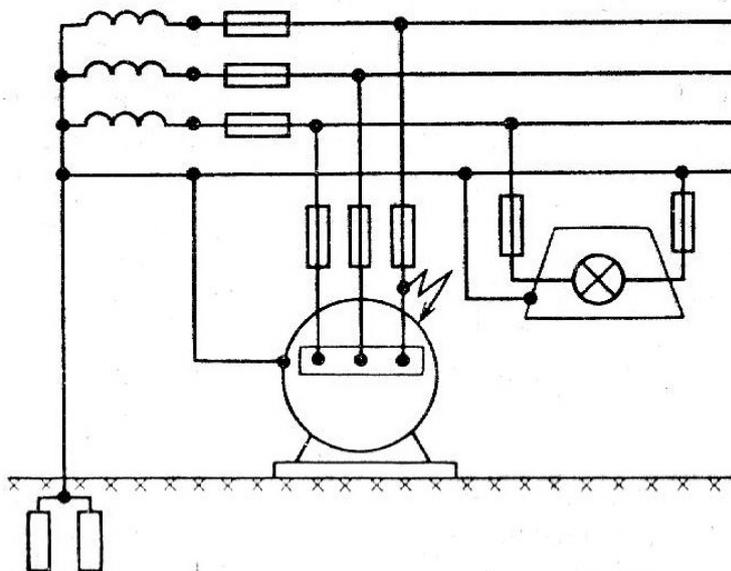
Рис. 12.15. Схема защитного заземления (зануления) в четырехпроводной линии
