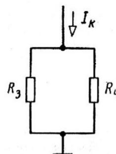
Рис. 12.12. Распределение тока утечки между телом человека и заземлителем
