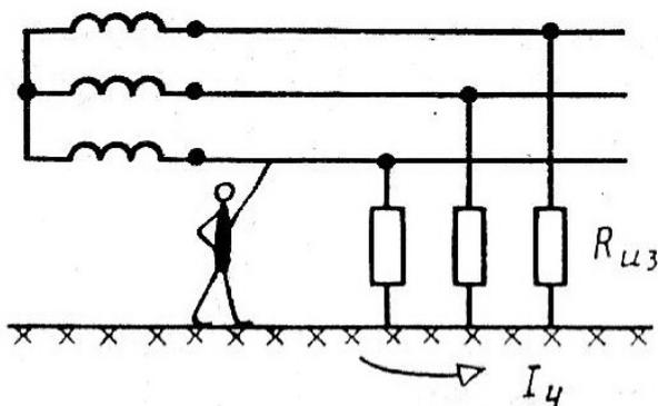
Рис. 12.9. Токи утечки в трехпроводной трехфазной линии
