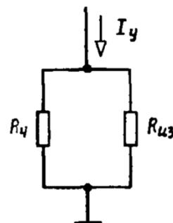
Рис. 12.10. Параллельное соединение сопротивлений изоляции и тела человека
