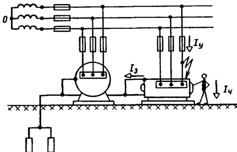
Рис. 12.11. Схема защитного заземления в трёхпроводной линии
