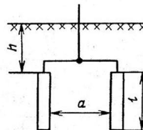
Рис. 12.16. Схема заземлителя
