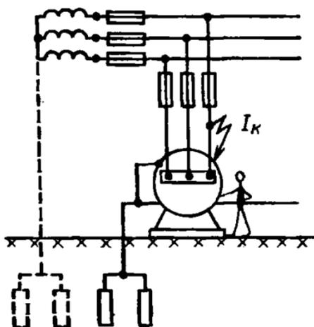
Рис. 12.13. Заземление нулевой точки в трёхпроводной линии
